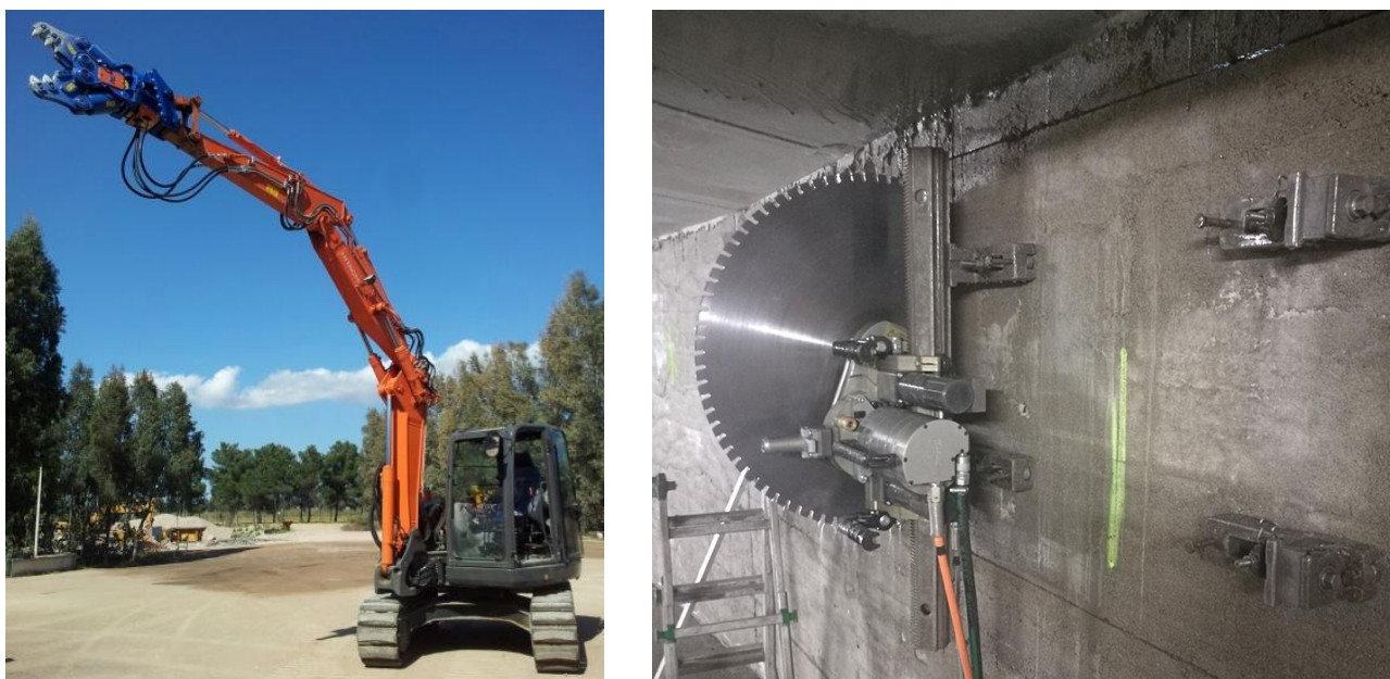
Figura 2 - Pinza idraulica demolitrice e sega con disco diamantato
